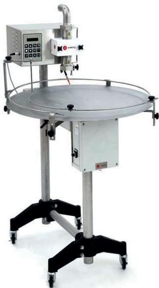
Les pots vides sont placés sur la table et transportés automatiquement vers une cellule photoélectrique.
